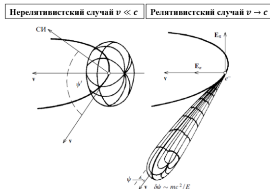
Рисунок 2 — Картина пространственного распределения излучения от движущегося по криволинейной траектории ускоренного заряда в нерелятивистском и релятивистском случае [8]
