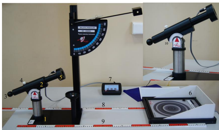
Рисунок 1 — Схема экспериментальной установки (a), пусковое устройство (b) 1 – металлическое основание пускового устройства; 2 – пусковое устройство; 3 – рукоятка взведения; 4 – спусковой рычаг; 5 – фотодатчик; 6 – сенсорная панель; 7 – таймер; 8 – измерительная линейка; 9 – направляющая линейка; 10 – угломерная шкала
