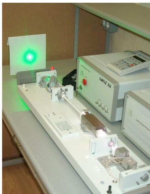
Рисунок 1 — Лазер на иттрий-алюминиевом гранате для специального практикума по лазерной физике и нелинейной оптике (БГУ, СП «Лотис ТИИ»)
