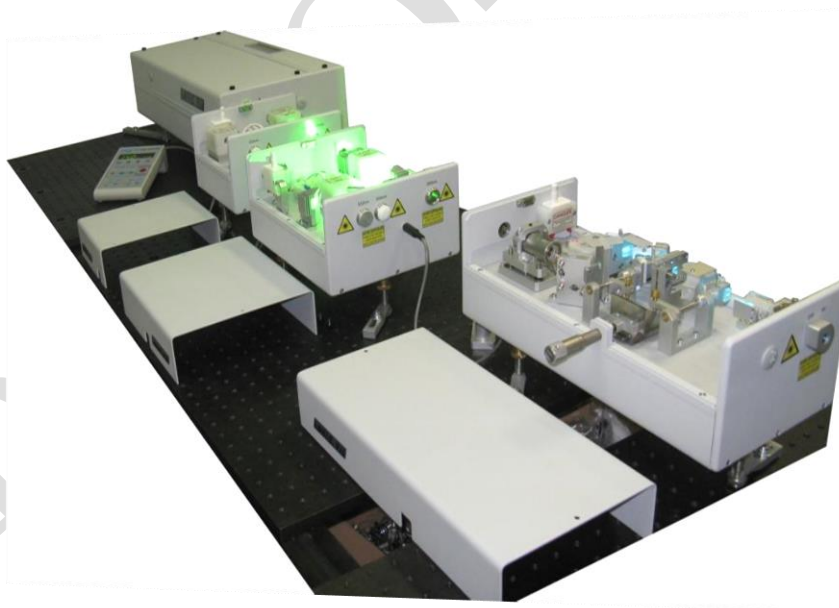
Рисунок 3 — Модульный нелинейно-оптический лазерный комплекс для изучения перестройки частоты на основе параметрических процессов
