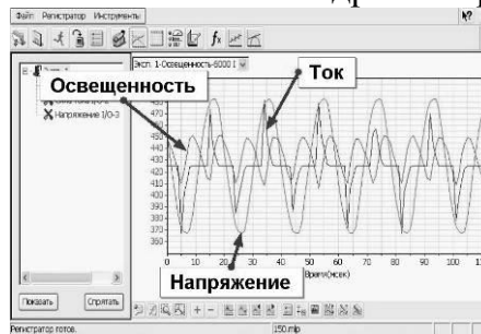
Рис. 7. Графики зависимости тока, напряжения и яркости свечения энергосберегающей лампы
