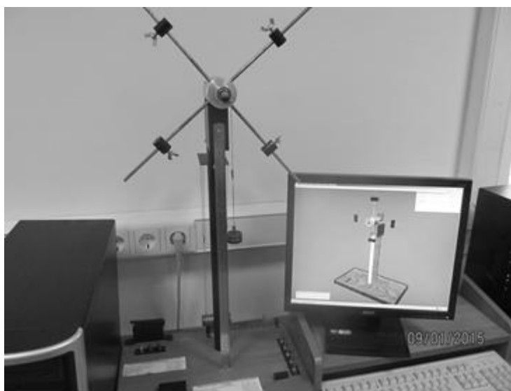
Рис. 1. Реальный лабораторный и виртуальный эксперименты «Маятник Обербека»
